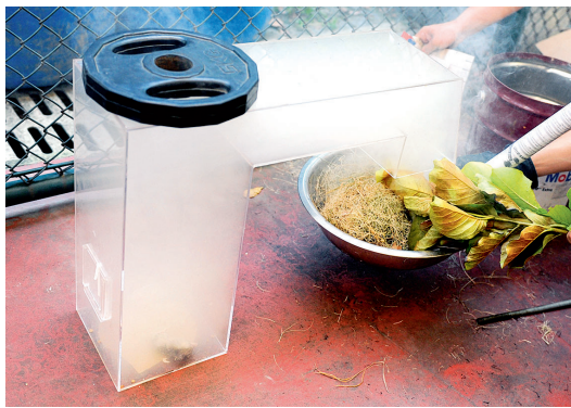
实验人员将干草燃烧的烟气灌入实验装置
