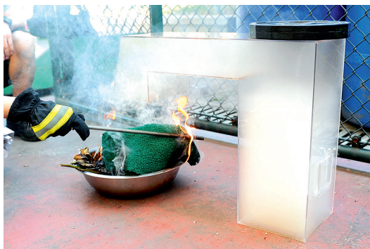
实验人员将橡胶燃烧产生的浓烟导入实验装置
