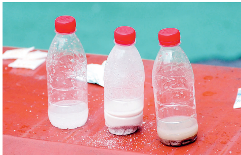
装有生石灰干燥剂的塑料瓶底部很快变形
