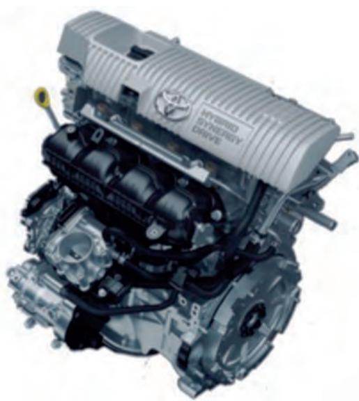
卡罗拉双擎的混合动力系统主要由两个动力源组成——1.8 升阿特金森循环发动机和电动机。阿特金森循环发动机最高输出功率达到 73 千瓦，它的特点是通过延迟关闭排气门，让发动机的膨胀比大于压缩比，从而提高燃油效率，但与此同时，发动机的输出功率会有所降低。从实际效能来看，这台发动机相当于普通 1.6 升发动机的功率输出和 1.4 升发动机的燃油消耗，而在 53 千瓦电动机的配合下，卡罗拉双擎实现了百公里仅 4.2 升的油耗，最大功率输出却达到了 100 千瓦。
