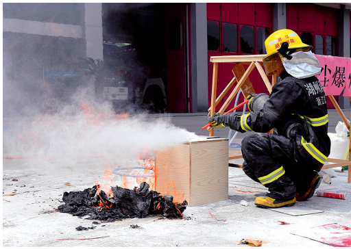
床头柜上的粉尘团遇到明火被迅速引燃
