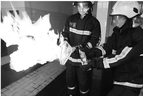
消防员模拟电蚊拍拍蚊状态,杀虫剂喷雾发生轰燃
