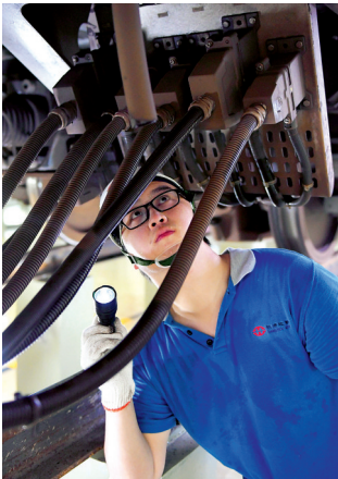
王宇文检查列车底部的防松线
