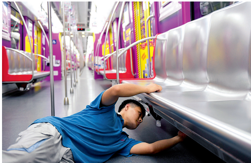
检查车厢内座位底下的加热器
