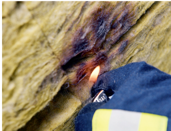
消防员无法用打火机点燃岩棉
