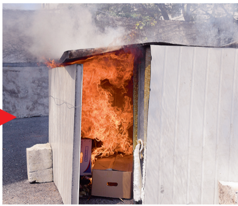
泡沫房被引燃后猛烈燃烧并变形
