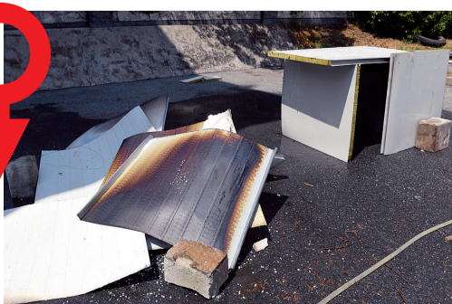
泡沫房轰然倒塌,岩棉房纹丝不动
