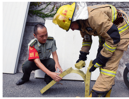
岩棉彩钢板内的岩棉夹芯
