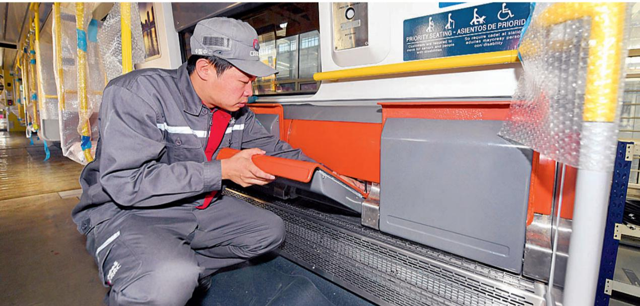
10月31日,在中车长客客车制造中心装配一车间,工人在安装波士顿地铁列车上的折叠座椅。
