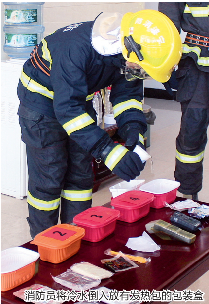
发热包遇水后,立即产生大量蒸汽
