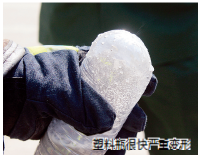
发热包混合物遇水后立即产生大量气泡
