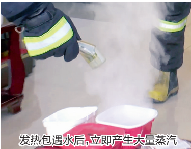
消防员将冷水倒入放有发热包的包装盒
