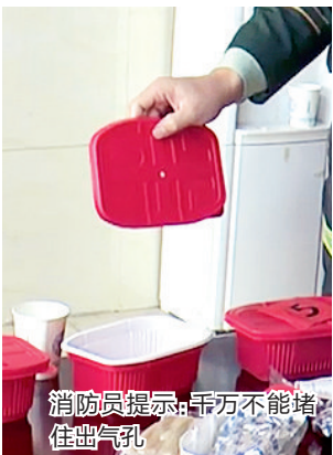
出气孔被堵后,包装盒迅速膨胀,温度也迅速升高
