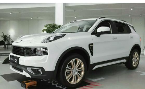
在这方面,领克01做到了。新车与与沃尔沃XC40共用CMA平台,发动机搭载的是沃尔沃研发的VEP4 2.0T发动机,改系列发动机也应用在S90、S60L;配合爱信第三代自动变速箱和7DCT混式双离合变速箱,能够实现7.7s(两驱)、7.9s(四驱)的0-100km/h加速成绩。同时,行业内首次搭载的博世ESP 9.3高动态版,让领克01在实现快速的同时,保证车身稳定。
