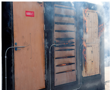
普通木门的缝隙处有大量明火冒出
