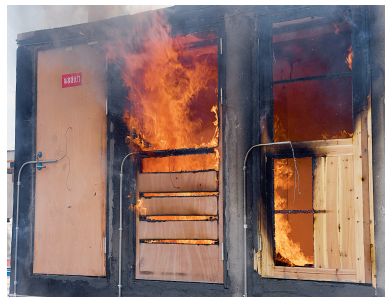
伪劣防火门和普通木门的门板烧穿掉落
