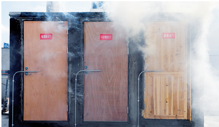
实验开始后,门缝处有不同程度的烟气飘散出来
