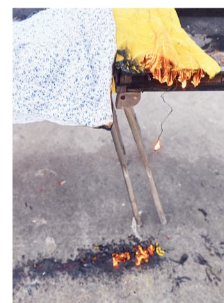
普通窗帘布燃烧后不停有带明火的熔化物滴落
