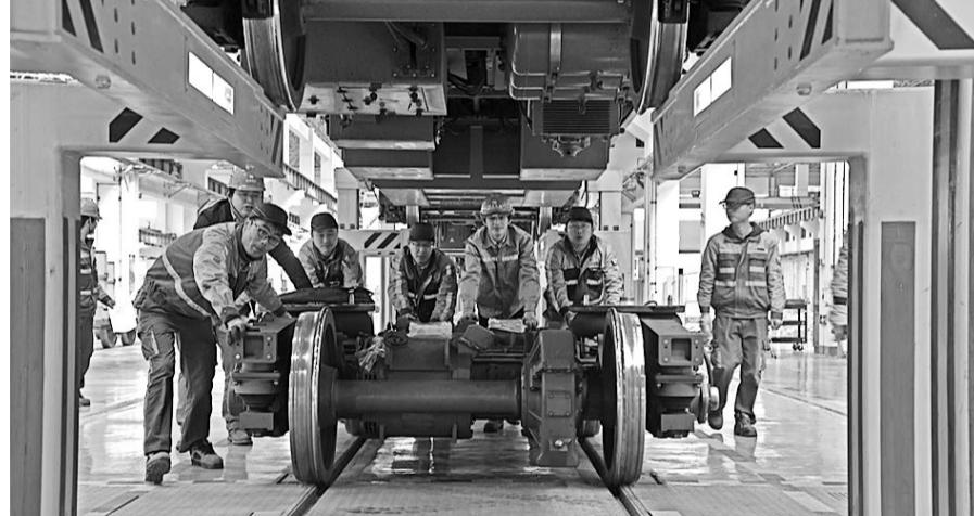
营公里数达120万的列车进行大修。“本次对‘02001’号的架修相当于是中期维护,主要是针对列车的车顶空调、受电弓、车下的转向架、轮对、制动系统、牵引电机、车钩等重要部件”。
