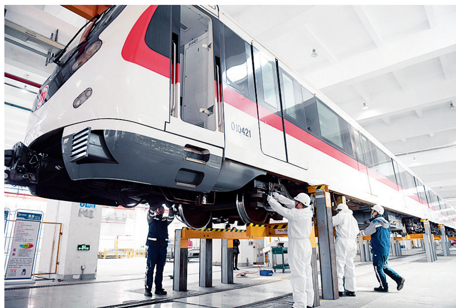
列车被固定式架车机顶起
