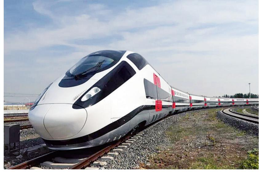
车迷们赞誉为动车组中的“变形金刚”。面对客流变化,如要扩大编组,这一动车组可根据速度和功率核算出效率最优搭配,在2至16节范围内随意变换搭配动车和拖车车厢,快速定制开行不同速度等级、编组数量和坐席配置的动车组列车,像搭积木一样灵活。如客
