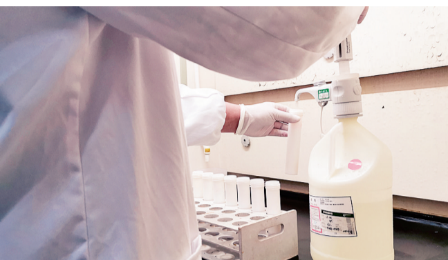
把硝酸加入样品中,进行微波消解,以便后续分离出重金属元素
