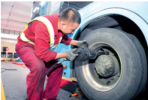
拆卸轮胎上的螺丝
