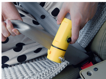
拉紧固定安全带进行正确切割
