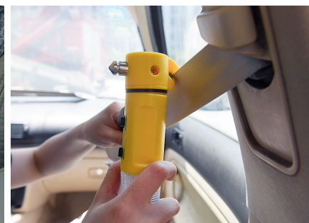
拉紧固定安全带进行正确切割
