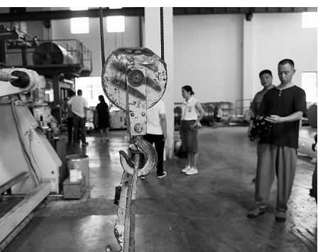
5吨的行吊未设置防脱落装置
