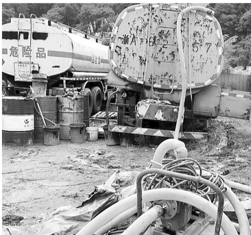
石油醚倒驳、分装的简易设备
