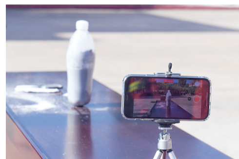
瓶体因膨胀严重变形
