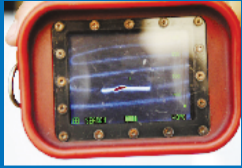
破损、老化的电热毯在通电后升温明显异常
