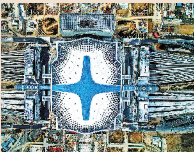
日前,“第十五届中国钢结构金奖”评选结果揭晓,杭州西站站房及相关工程榜上有名,这是中国钢结构行业工程质量的最高荣誉。作为“轨道上的长三角”重要节点工程、杭州亚运会重大配套设施,杭州西站枢纽站房总建筑面积约58万平方米,是一座集高铁、地铁、公交、出租等出行方式于一体“站城融合”的特大型综合交通枢纽,钢结构总用钢量约4.98万吨。其中,站房屋盖钢结构总长约326米、宽约245米,总重量约1.1万吨,是杭州西站工程建设的“重中之重”。图为俯瞰正在建设中的杭州西站站房。
