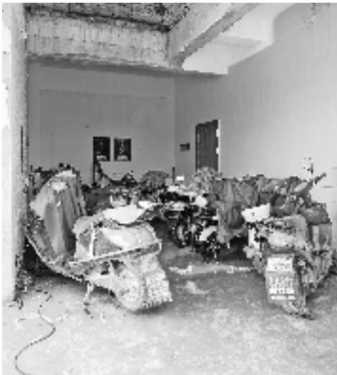
模拟楼梯间内违规停放电动自行车充电
