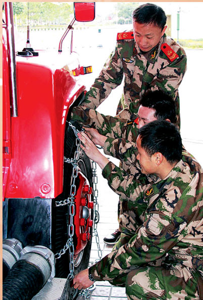
湖州市消防支队吴兴区大队对所有执勤车辆和器材装备进行了认真细致的安全检查,还为执勤车辆安装上了防滑链
