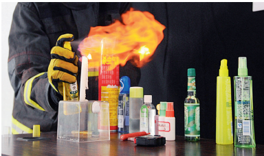
消防员喷射出的花露水出现轰燃效果
