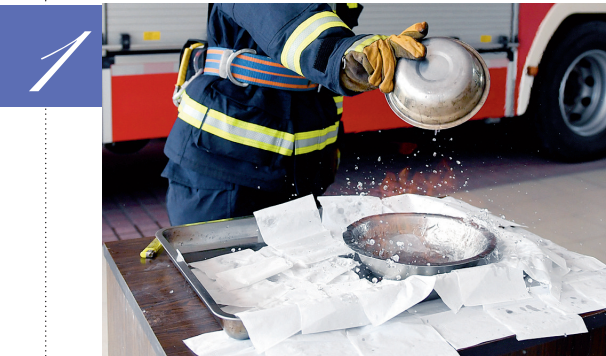
消防员将水倒入燃烧的酒精
