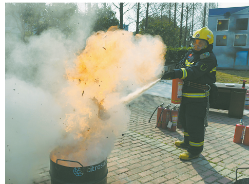
伪劣灭火器灭火时出现轰燃现象
