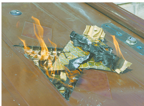
普通铁门的纸板填充物被引燃
