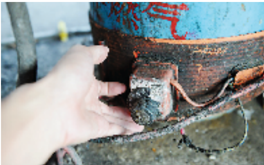
液化气瓶底部竟然安装了加热装置
