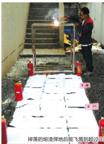
高空电焊作业时,掉落的熔渣位置更具不确定性
